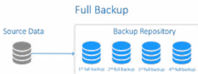
2-rasm. Ma'lumotlarni to'liq zaxiralash ketma-ketligi
