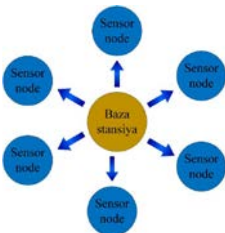
2-rasm. Yulduz topologiyasining tuzilish sxemasi
