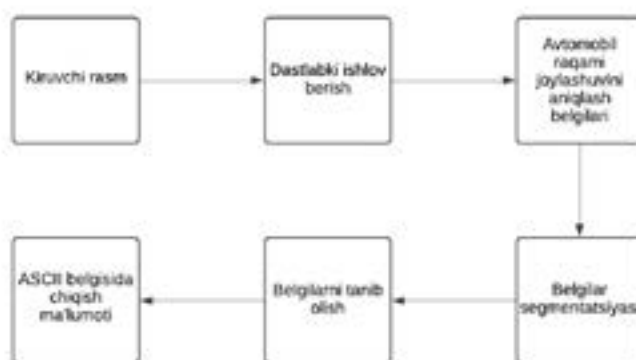
2-rasm. Avtomobil raqamini tanib olish jarayoni.
